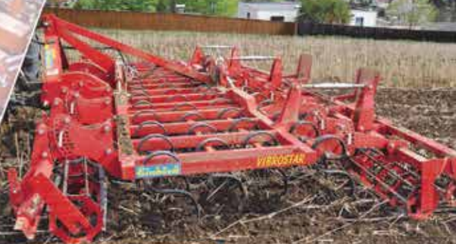
VIBROSTAR 4-490 2ZW LATIME DE LUCRU: 4.9 m CU 49 ORGANE ACTIVE
