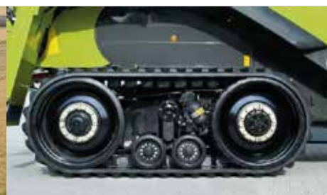
2003/2004: Implement pivotant pe punte și suspensie cu elemente din cauciuc.
