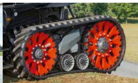
2019: AXION TERRA TRAC intră în producția de serie cu un concept de semi-șenile cu suspensie completă și două modele.
