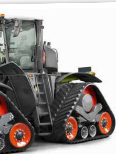
Șenilele TERRA TRAC care echipează modelul XERION 12, sunt caracterizate prin durabilitate și proprietățile de autocurățare.
